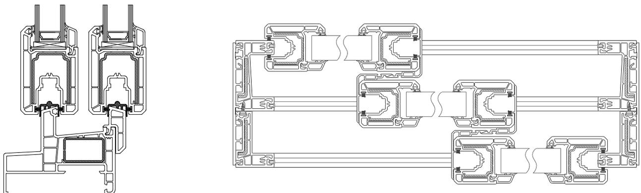
Pour éviter l'assemblage avec les tapées, augmenter l'étanchéité et l'isolation, notre solution ... : les dormants larges 6108, 6109, 6110 et 6111.
